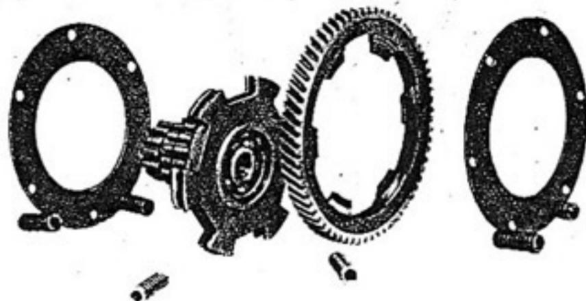
la couronne de tourner légèrement sur le train de pignons primaires en comprimant les ressorts amortisseurs placés entre les dents du plateau. On arrive donc à avoir une certaine élasticité entre ces deux pièces, ce qui permet d'absorber les à-coups du moteur à bas régime. Le centrage de la couronne sur le train de pignons étant fait par ce système de glissières, les flasques métalliques n'ont plus pour but que le maintien en position des ressorts.
